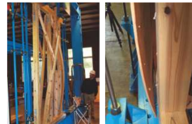
破損した45mm筋交い 外れてしまう構造用合板
